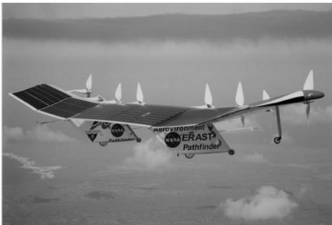
O Pathfinder foi desenhado para ser um avião leve e pilotado remotamente, movido a motores eléctricos alimentados por painéis solares (células fotovoltaicas), para voar a altas altitudes e durante muito tempo. O objectivo de todo o projecto era criar uma plataforma científica que se pudesse sustentar muito alto e durante muito tempo e adaptar-se a qualquer tipo de missão que o exigisse.
